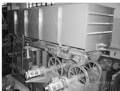
图1 同济大学的 1:5 铁道车辆滚动实验台
