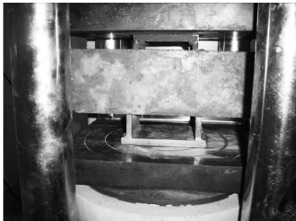
图 3 混凝土抗剪强度试验照片
