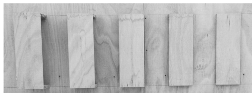
图 5 距离分辨率测试靶板
