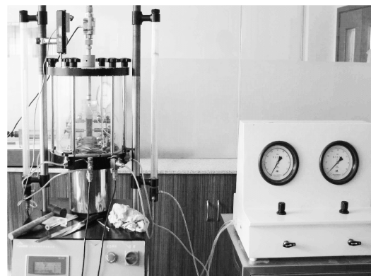
图 2 同济大学平面应变仪
