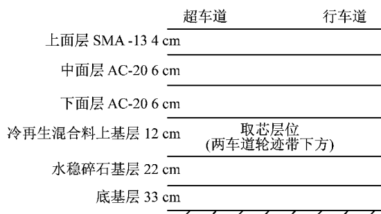
图 1 昌九高速公路路面结构及取芯位置
