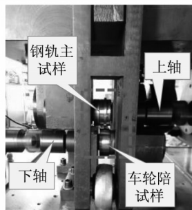
b MJP滚动接触疲劳试验机试样实际接触状态
