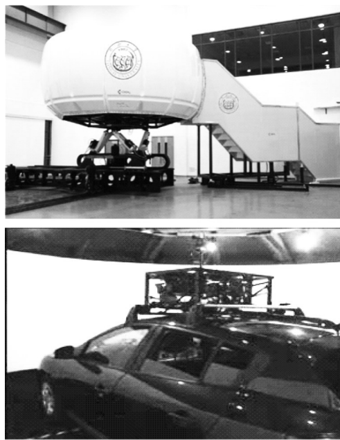
图1 驾驶模拟器示意
