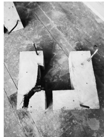
图19 DS2试件破坏模式
