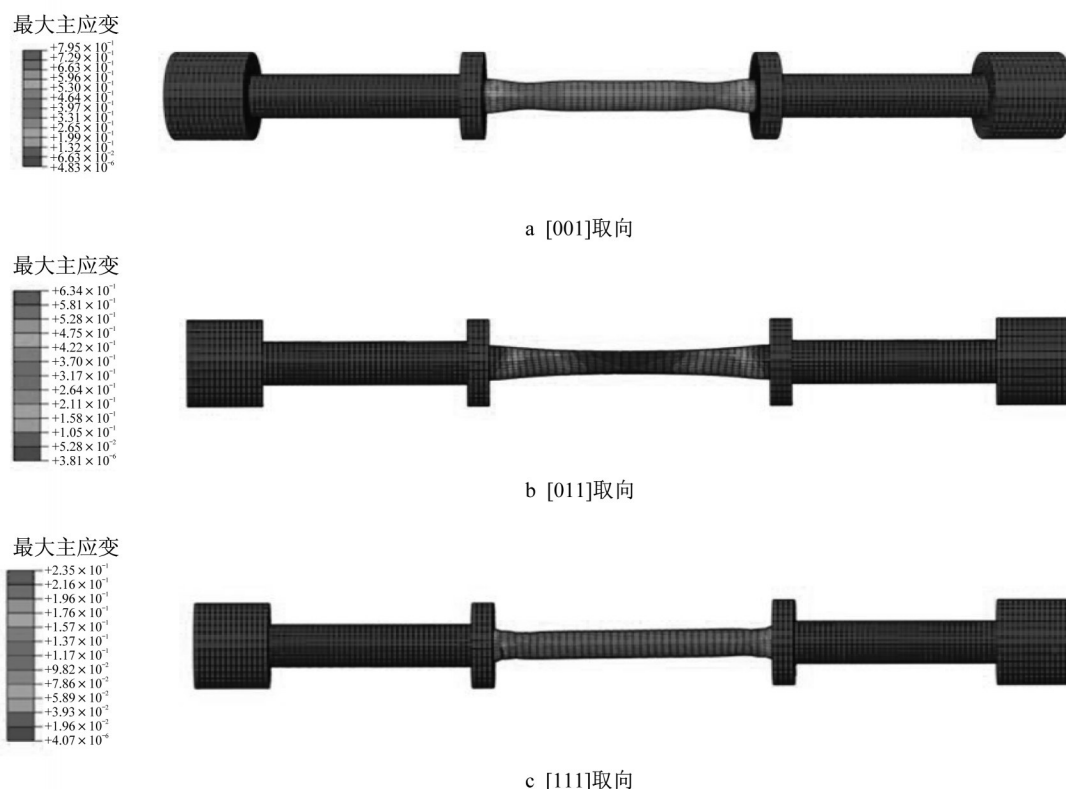
图9 3种取向980°C/300MPa有限元仿真结果
