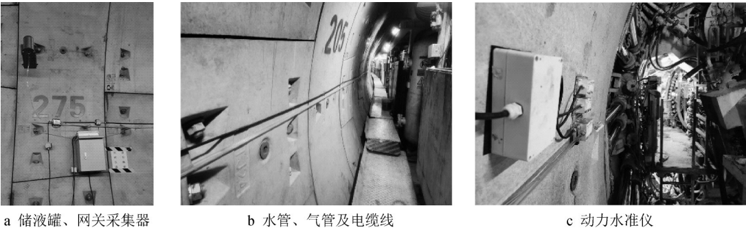
图4 试验装置 Fig. 4 Test equipment
