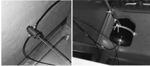
图2 传感器和激振器布置
