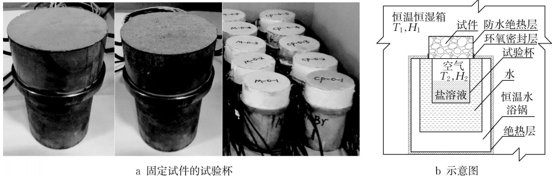
图5 热湿耦合传输试验布置
