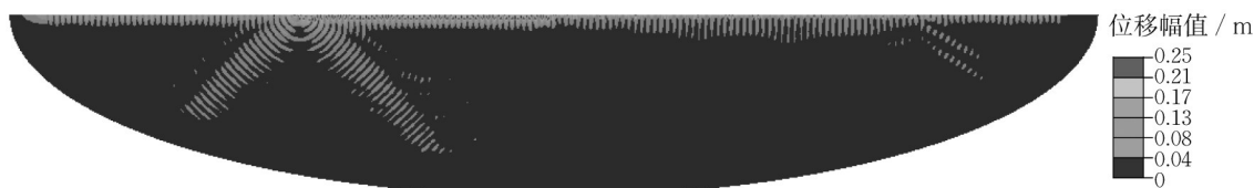
图7 采用绑定约束条件时在9.0 Hz的集中谐波载荷激励下介质内的位移幅值分布
