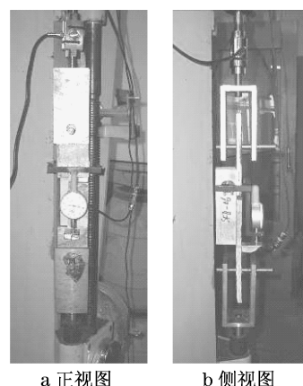
图 2 钉连接试件及试验装置
