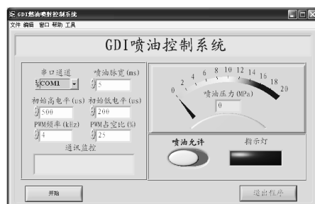
图 8 直喷喷油器喷雾实验控制系统界面 Fig.8 Testing control interface of GDI injector
