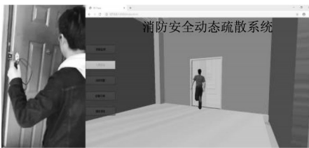
图11 人员携带标签位置在网页端的BIM模型中展示
