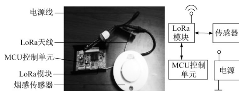
图4 数据采集终端及其组成结构
