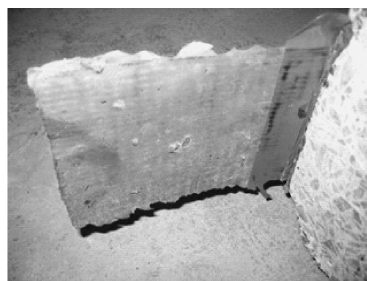
图 3 胶层与混凝土界面破坏(a 型)
