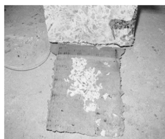
图 4 表层混凝土剥离破坏(b 型)
