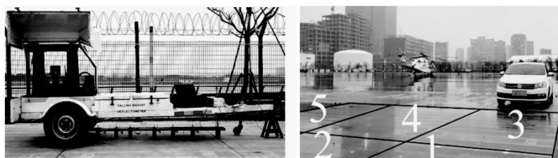
a FWD加载以及移动车辆加载实物图
