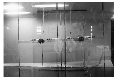
图5 3^\circ 风攻角时平行双幅桥试验节段模型
