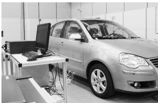
图1 刮水器振动与噪声测试现场
