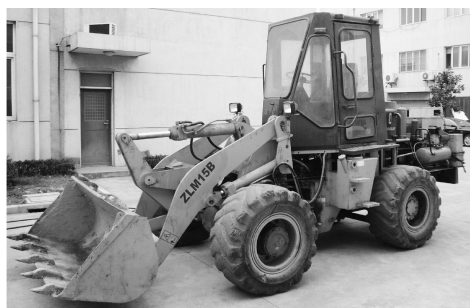
图1 永磁同步电动轮驱动装载机 Fig.1 PMSEW driven loader
