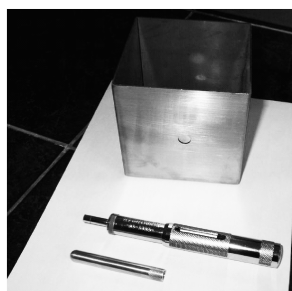
图3 贯入试验仪
