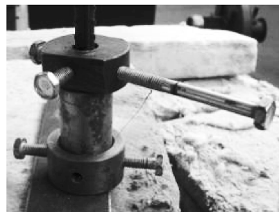
图3 位移测量装置
