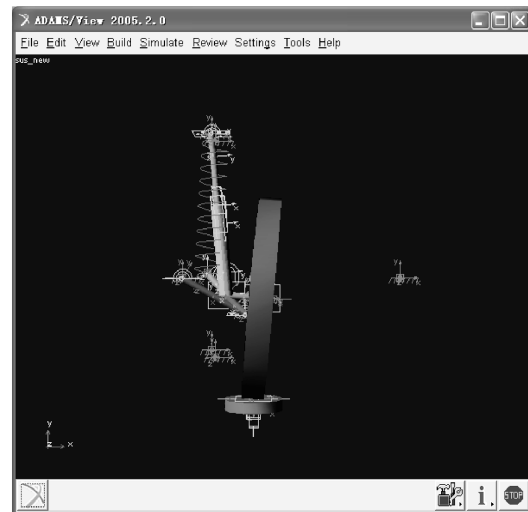
图4 添加驱动和约束后的模型
