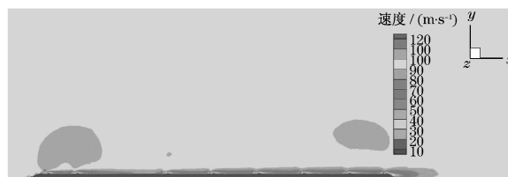
图 13 第 2 节车未装制动风翼时速度云图
