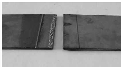
图 11 胶接接头塑性变形
