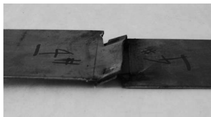
图 13 胶焊接头塑性变形
