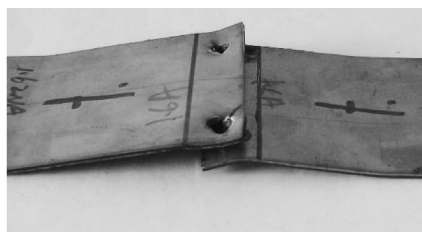
图 12 点焊接头塑性变形
