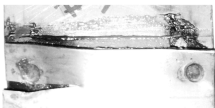
图 9 胶焊接头疲劳破坏形式 I
