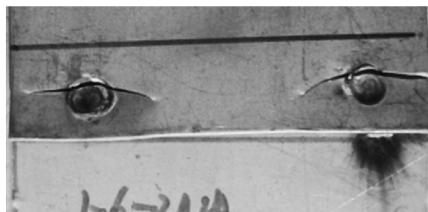
图 7 点焊接头疲劳破坏形式 I
