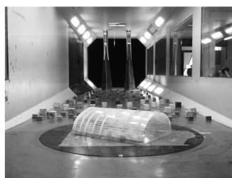
图 7 风洞试验中的柱面网壳刚体模型
