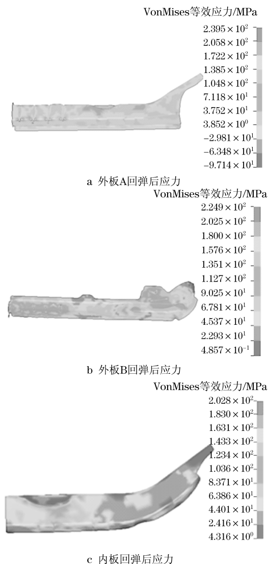
图 5 冲压成形仿真零件回弹后的 VonMises 等效应力
