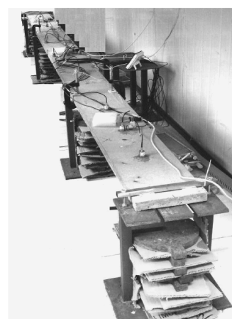
图 4 混凝土连续梁模型
