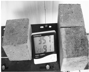
图 13 湿度试验装置 Fig.13 Humidity experimental instrument
