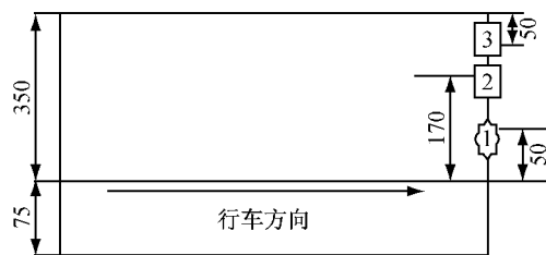
图3 错台量测试点位置平面分布(单位:cm)
