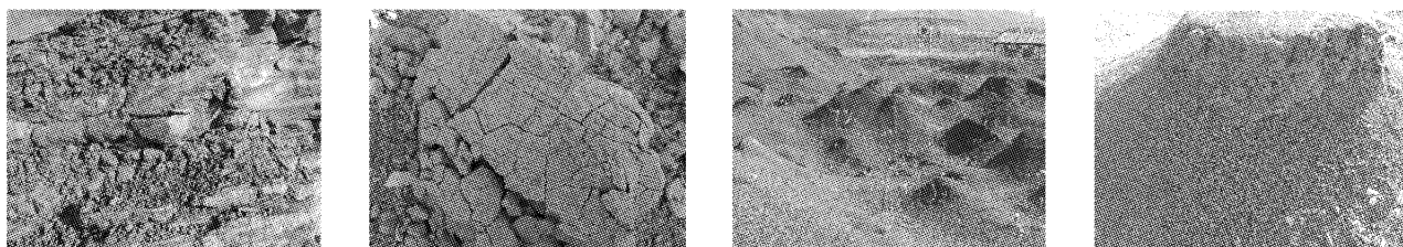
图 1 野外泥质页岩的崩解现象
