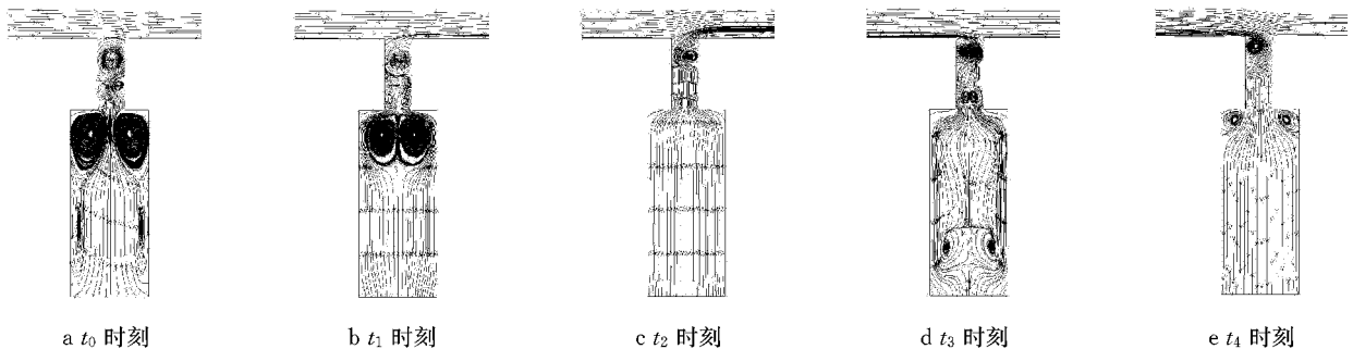
图 12 在面 y=0 上的合成射流不同相位下的流线 Fig.12 Streamlines in different phase of the jet in plane y=0
