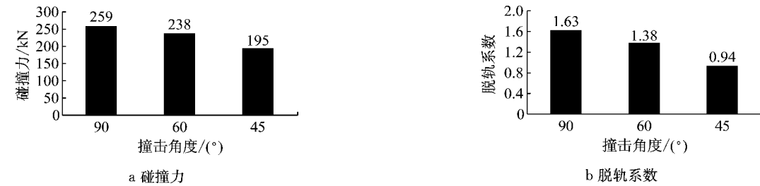
图 8 撞击角度对有轨电车动态响应的影响
