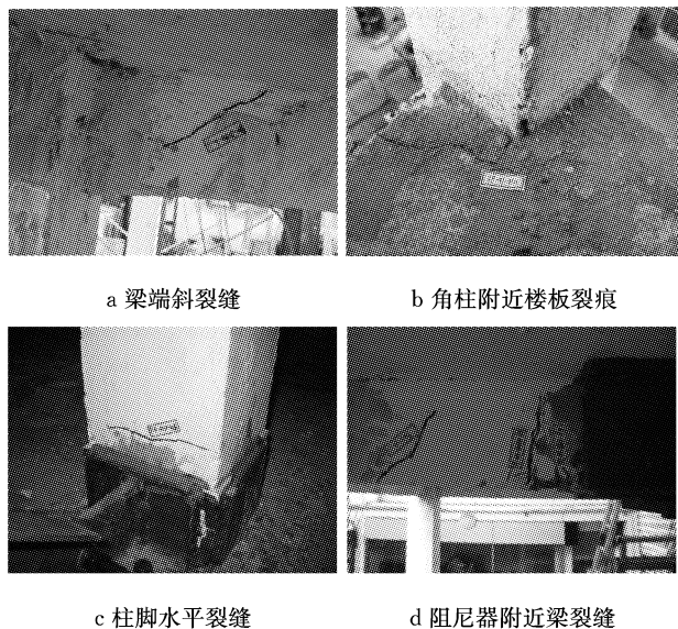
图 8 减震框架试验现象
