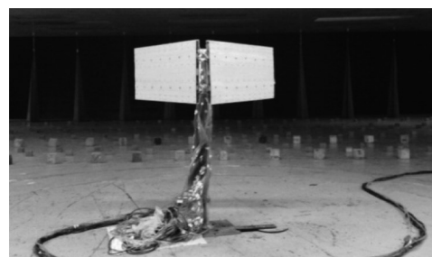
图4 试验模型与风洞布置
