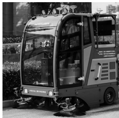
图 4 试验平台车: 低速智能电动清扫车
