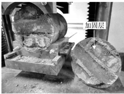
图13 芯样加固层破坏形式
