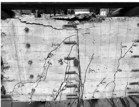
图11 Z2试验梁破坏裂缝图
