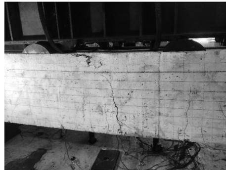
图9 C30简支梁破坏裂缝图
