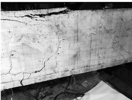
图12 Z3试验梁破坏裂缝图
