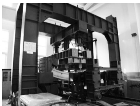
图2 TJ-GPJ2000盾构隧道管片接头加载系统
