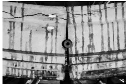
图17 负弯矩变形接头极限破坏形式(N=1 300kN)
