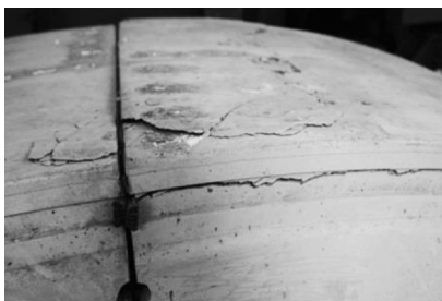
图16 正弯矩变形接头极限破坏形式(N=1 300kN)
