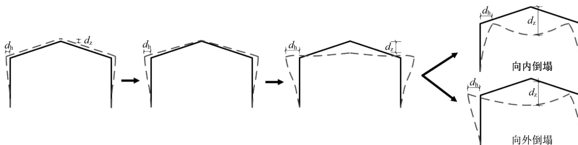
图11 倒塌过程与机理
