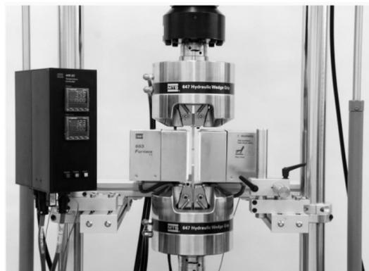
图1 高温电子材性试验机
