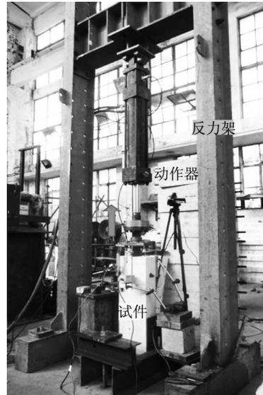
图5 试件加载装置
