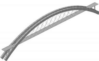
图15 尼尔森体系拱桥有限元模型
