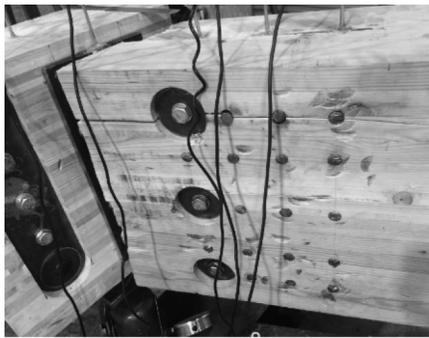
图15 木节点破坏形态
