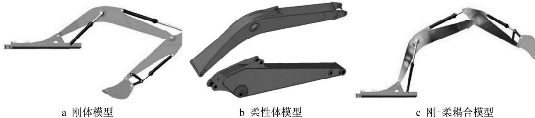
图3 刚-柔耦合模型的建立
