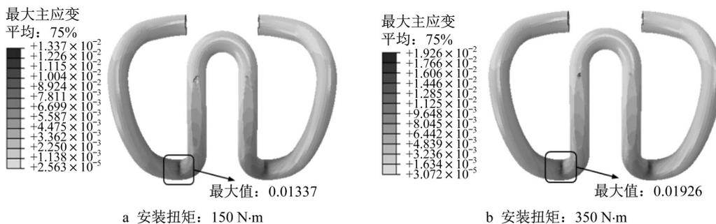
图 9 不同安装扭矩下弹条表面应变分布
