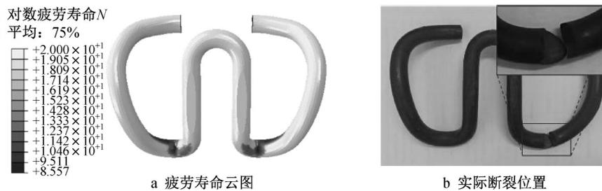
图 13 弹条计算疲劳寿命与实际断裂特征对比
