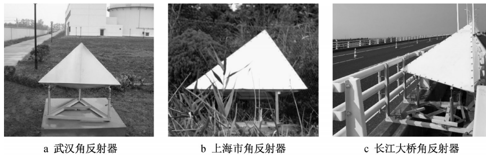
图2 布设于武汉/上海的角反射器
