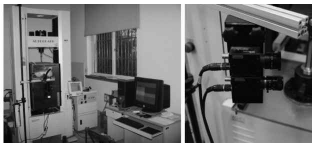
a 单调拉伸试验机 b 视频引伸计
