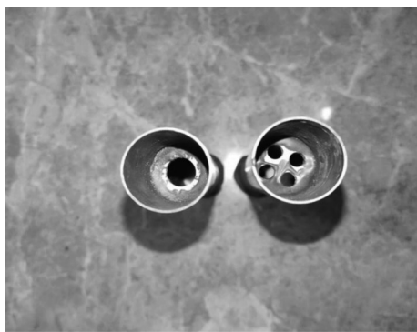
图2 离心试验中新型单桩基础
