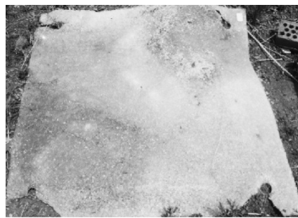
图2 破碎后夹层玻璃的碎片黏结情况 [5]
