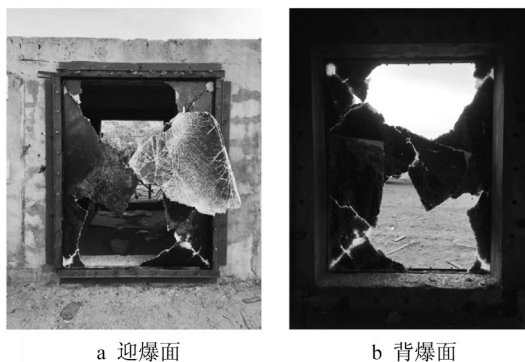
图16 混合型破坏(10kg@10m)
